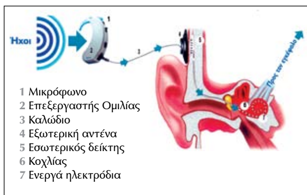
ΕΙΚΟΝΑ 3. Τρόπος λειτουργίας κοχλιακού εμφυτεύματος.
