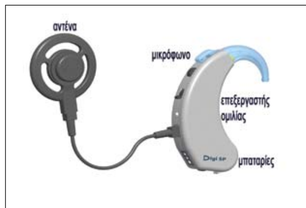
ΕΙΚΟΝΑ 1. Εξωτερικό τμήμα κοχλιακού εμφυτεύματος (αντένα, καλώδιο, επεξεργαστής ομιλίας).
