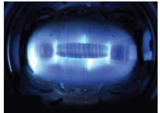
Φωτογραφία του πρώτου πλάσματος που παράγαγε το KSTAR Tokamak, χάρη στις τεχνολογίες της Air Liquide (Νότια Κορέα – Ιούλιος 2008).
